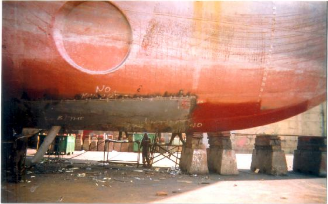
Hình 3.2: Ảnh chụp một số tấm tôn khu vực mũi được thay mới.
